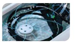
Система 360° спринклерного орошения создает турбулентность в моющем растворе, что, благодаря механическому воздействию, оптимизирует очистку эндоскопа.
