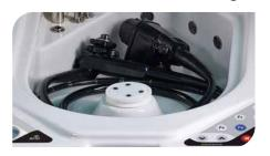
Опционально endoCleaner оснащен сигнальной системой мониторинга проходимости каждого канала эндоскопа, что гарантирует качественную очистку и дезинфекцию во время цикла обработки.
